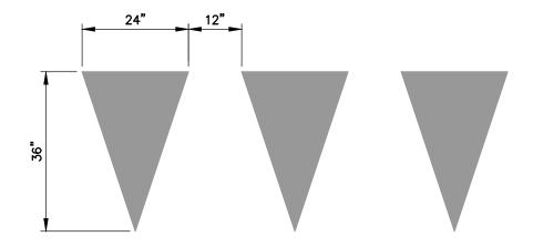
NOTE: TRIANGLE HEIGHT IS EQUAL TO 1.5 TIMES THE BASE DIMENSION.
